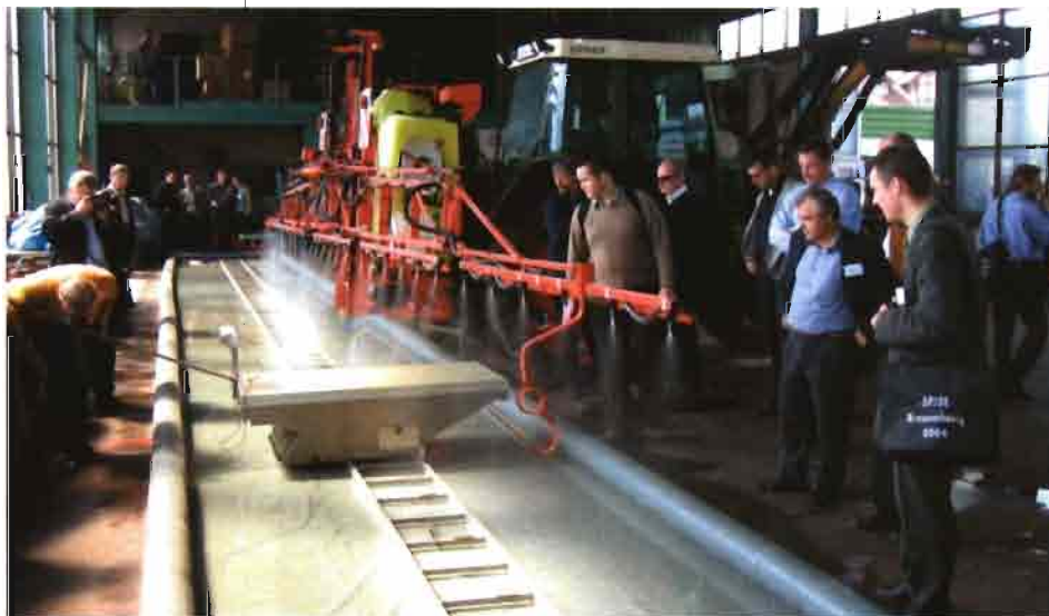
Reunión internacional de especialistas en aplicación de fitosanitarios, celebrado en Braunschweig en abril de 2004. Vista de un banco de ensayo móvil para la determinación de la uniformidad de distribución transversal de pulverizadores para cultivos bajos.
