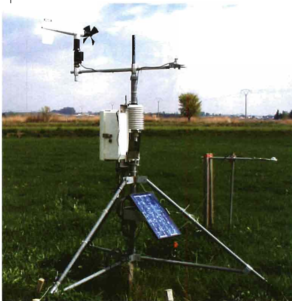
Estación meteorológica automática con sensores de radiación solar, radiación neta, velocidad y dirección del viento, temperatura y humedad relativa del aire.
