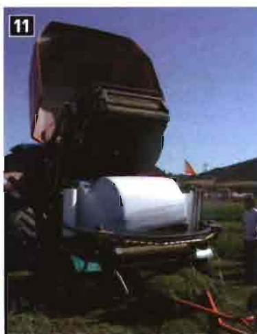
Foto 11. Sistema de encintado incorporado a la cámara de compresión.
