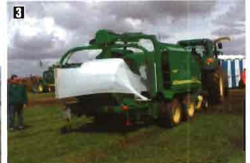
Foto 6. Rotoempacadora de cámara fija con rodillos metálicos.
