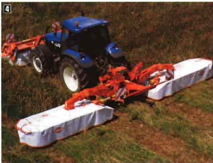
Foto 2. Barra de corte de discos triangulares con tres cuchillas.
