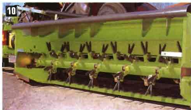
Foto 6. Sistema de regulación de la presión del cabezal de siega sobre el terreno.
