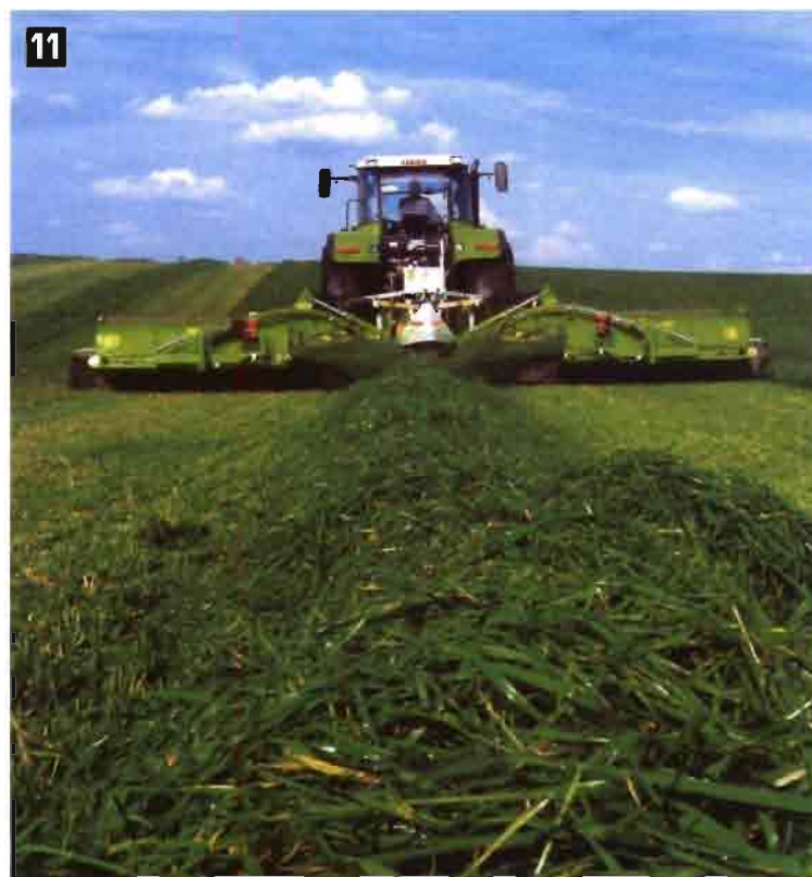
Foto 11. Cintas transportadoras traseras que permiten dirigir el forraje hacia el centro de la segadora.
