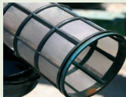
En la foto superior, se aprecian los residuos tras la aplicación de un oxiclورو mezclado con un abono foliar. En la inferior, los filtros aparecen limpios tras la aplicación de cobre Nordox junto a un abono foliar.
