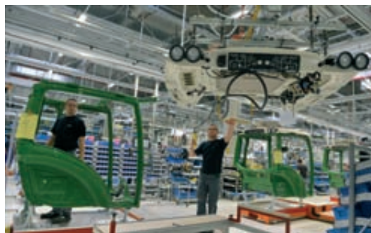
En el nuevo pabellón de montaje de la planta de Asbach-Bäumenheim, las cabinas se montan en la misma secuencia que en Marktoberdorf.
