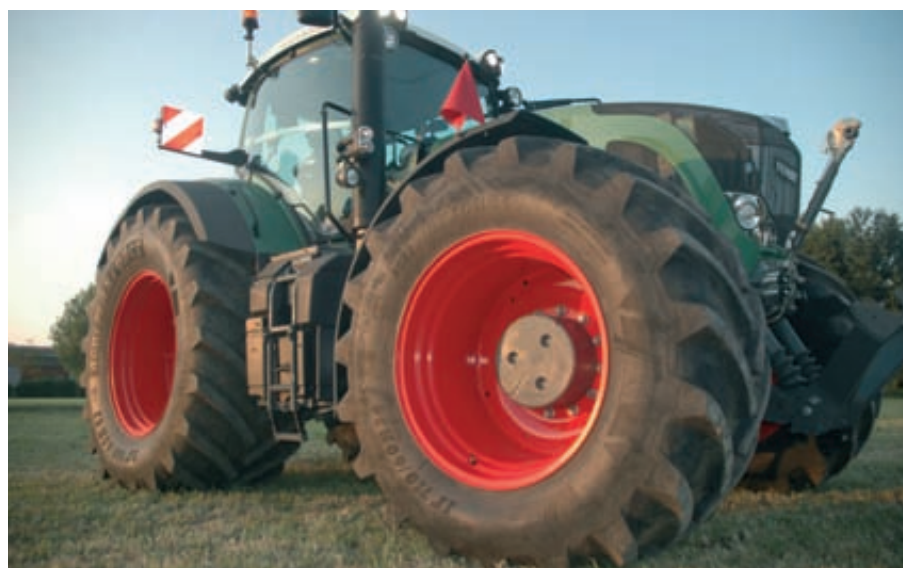
Foto 2. Los neumáticos radiales aportan una mayor durabilidad y una menor compactación del terreno.
