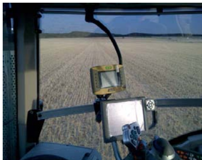
Vista del interior de la cabina de un tractor con sistema de auto-guiado (consola Topcon).
