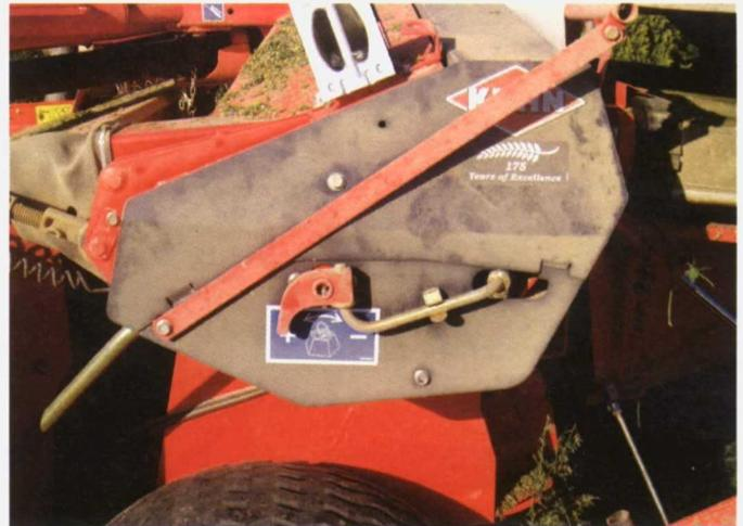
Foto 4. Sistema de regulación de la presión del cabezal de siega sobre el terreno.
