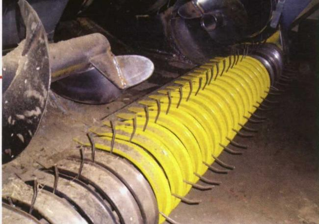
Foto 9. Pick-up de una macroempacadora de pacas prismáticas.
