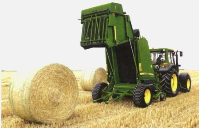
Foto 11. Rotoempacadora de cámara variable.
