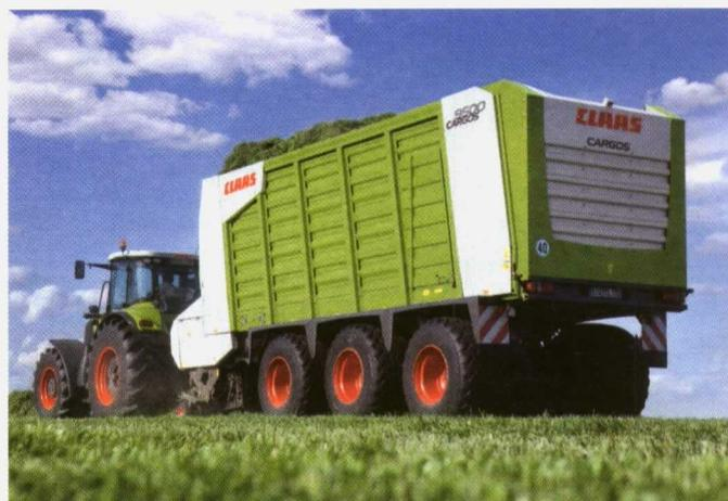
Foto 8. Remolque autocargador.
