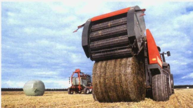
Foto 10. Rotoempacadora de cámara fija.
