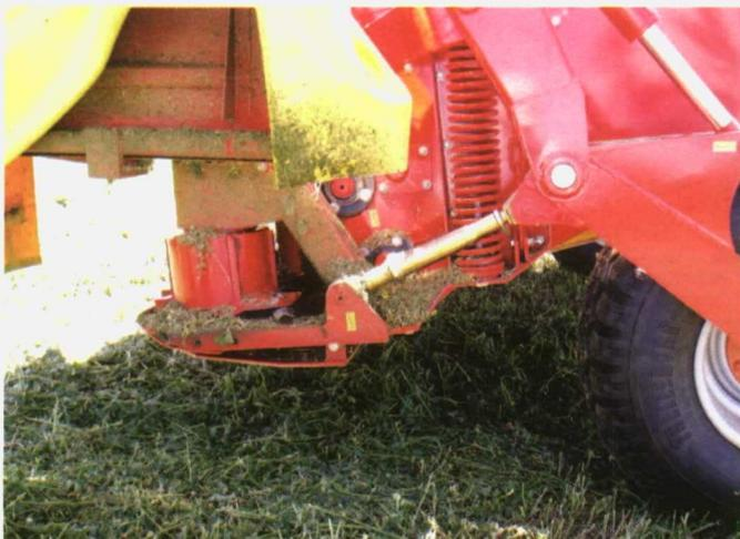
Foto 6. Tornillo regulador de la presión ejercida por los rodillos acondicionadores.
