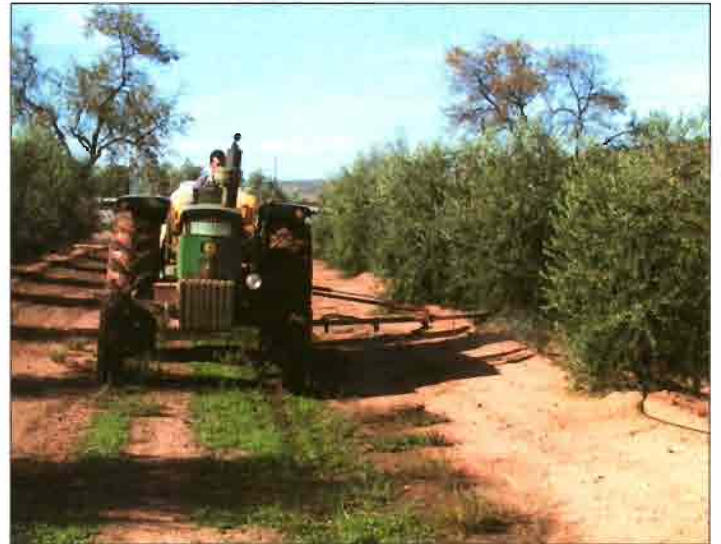
Uno de los métodos de control de malas hierbas alternativos al laboreo es el empleo de herbicidas. La utilización de una maquinaria adecuada para su aplicación es fundamental para lograr una buena eficacia y reducir los riesgos de contaminación ambiental. En la foto una barra equipada con boquillas de chorro plano aplica herbicidas en otoño en la línea de plantación de un olivar intensivo cultivado con cubierta vegetal en el centro de la calle. En este caso se dejará crecer la cubierta hasta el principio de la primavera.
