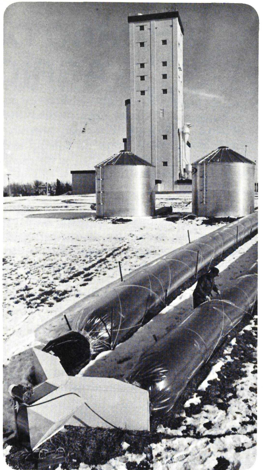
Colector solar de tubo de plástico inflado, para calentar aire para secado de granos. Cada tubo tiene 30 metros de longitud y entre los dos suministran un caudal de aire caliente de 70 m. 3 /minuto, impulsado por un ventilador de un CV. (Foto USDA.)
