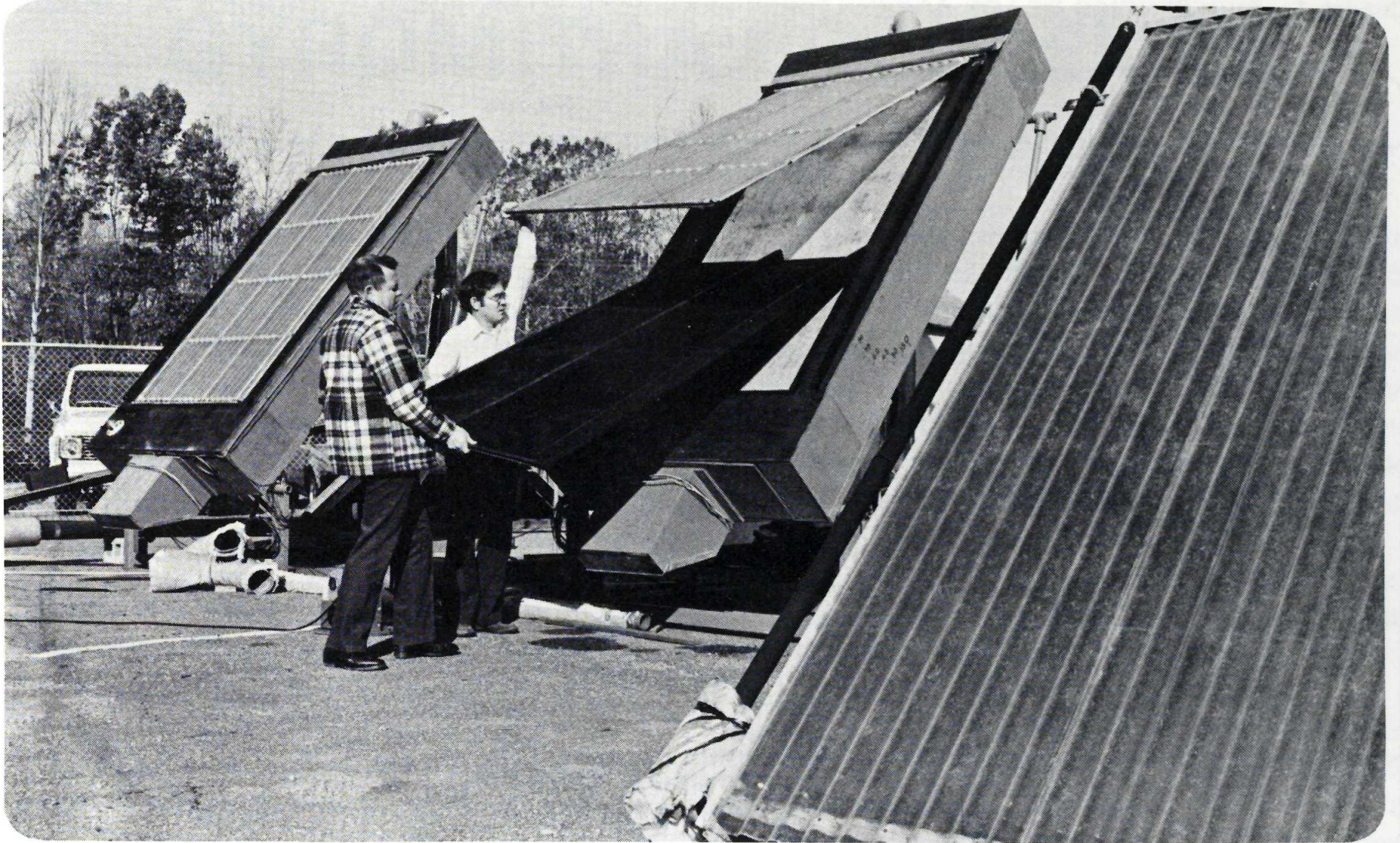
Colectores planos de energía solar para calentar aire para secado de granos y calefacción. (Foto USDA).
