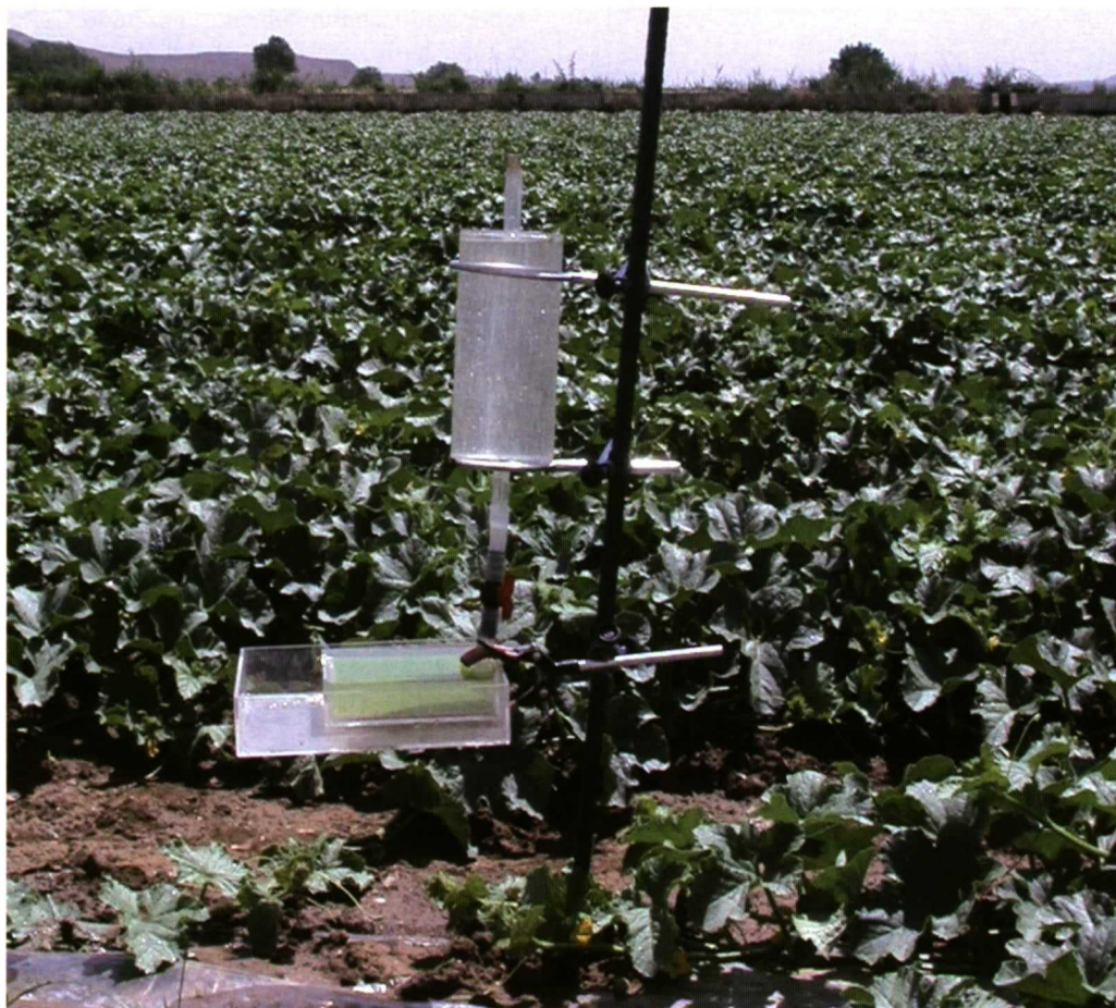
Figura 1. Trampa húmeda tipo Irwin, con dispositivo de llenado acoplado.
