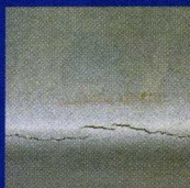
Cuarateamientos en un tanque de lastre tratado con un producto epoxi convencional
