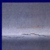
Cuar-teamientos en un tanque de lastre tratado con un producto epoxi convencional
