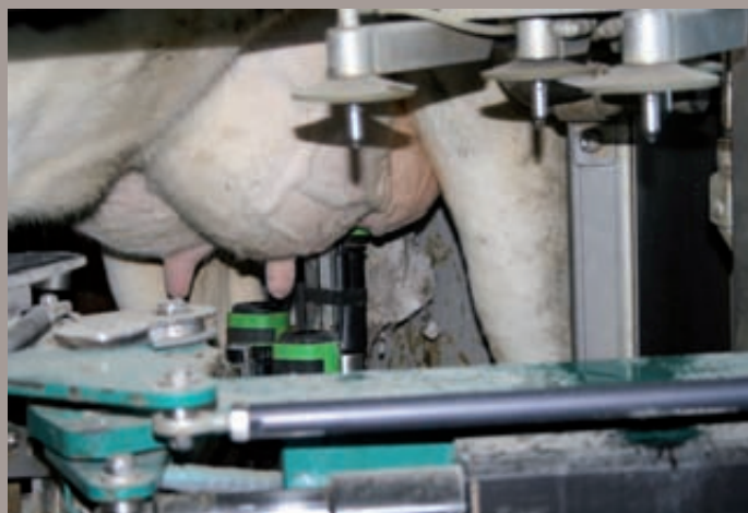
Brazo robotizado colocando las pezoneras.
