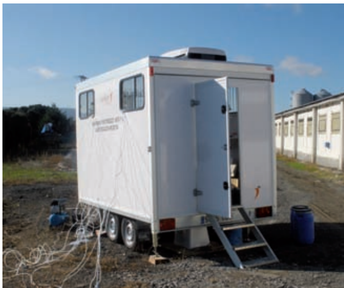
Foto 1. Unidad móvil de monitorización de gases.
