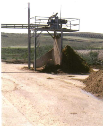
Separador de purines. El estiércol se vende para la producción de humus de lombriz, mientras que el purín se utiliza en la propia explotación agrícola.
