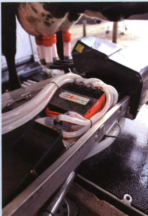
Foto 1. Sistema de control de calidad en el brazo de ordeño robotizado.
