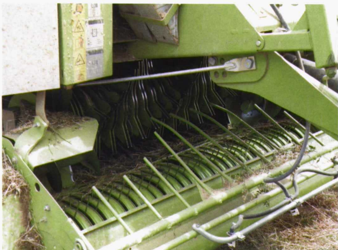
Foto 5. Dispositivo de picado incorporado antes de la cámara de empacado.
