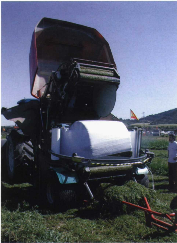
Foto 9. Encintadora con incorporada a la cámara de compresión de la empacadora.
