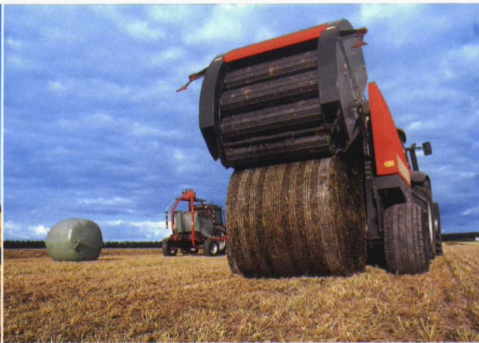
Foto 4. Rotoempacadora de cámara fija.
