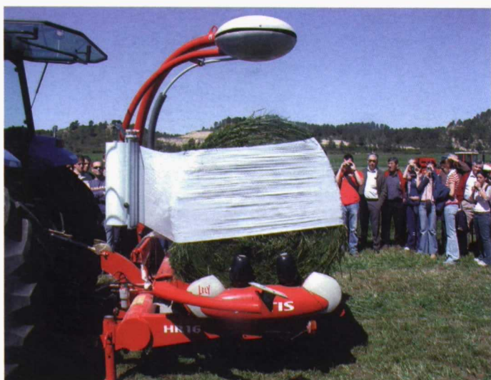
Foto 7. Encintadora con plataforma giratoria y un brazo satélite de aplicación de film plástico.
