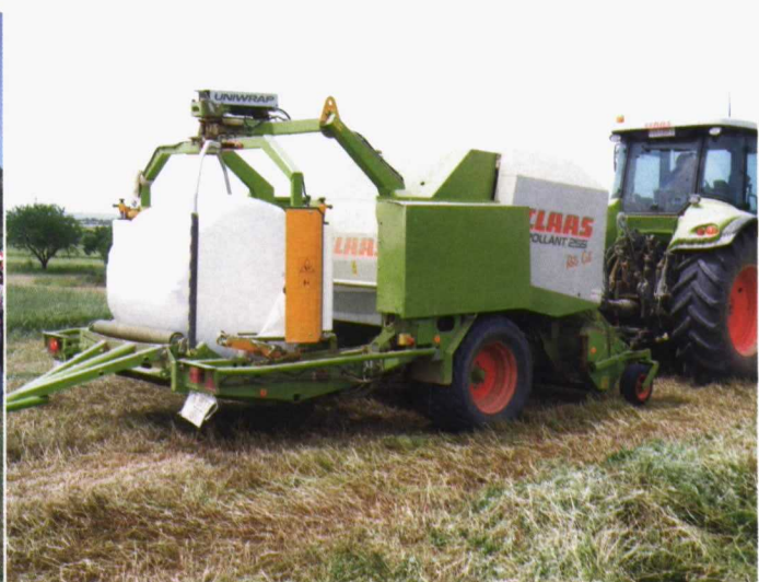
Foto 8. Máquina combinada compuesta por empacadora y encintadora.
