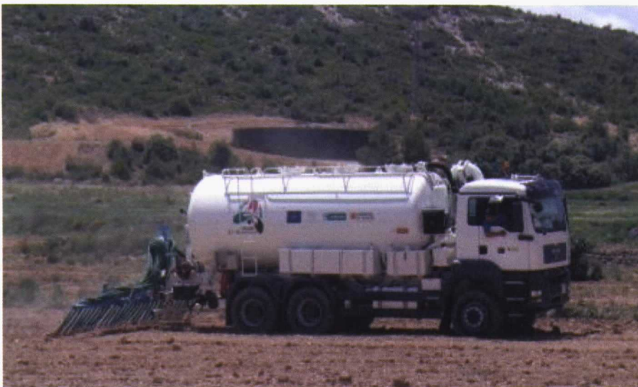
Foto 2. Camión aplicando purín con el sistema multitubos. Al fondo, un depósito para el almacenamiento intermedio de purín con capacidad de 1.500 m 3 .
