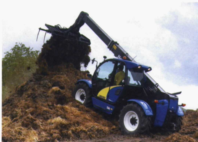
Foto 5. Cargadora trabajando con horca para estiércol. Documentación New Holland.
