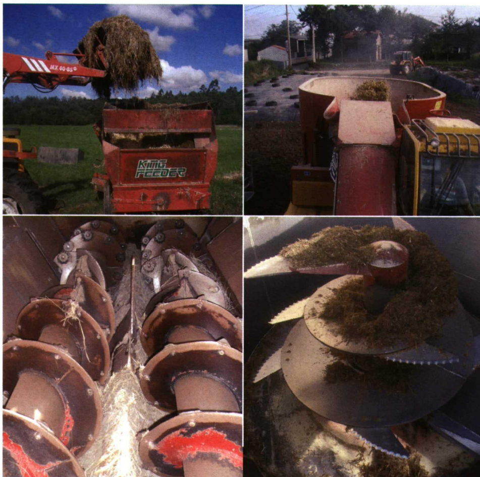
Figura 2. Carros mezcladores del tipo horizontal accionado con sistema de carga ajeno, y vertical autopropulsado con sistema de carga propio.
