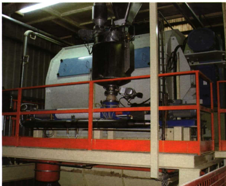
Figura 1. Mezcladora para la aplicación de aditivos al final del proceso.
