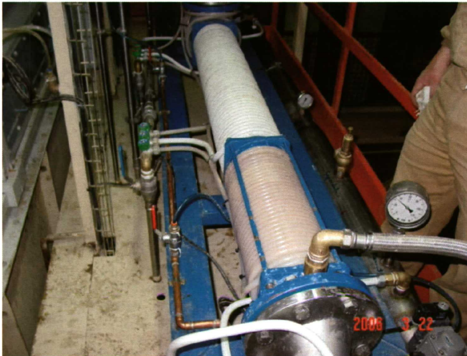
Figura 3. Pulverizador de la grasa de recubrimiento.
