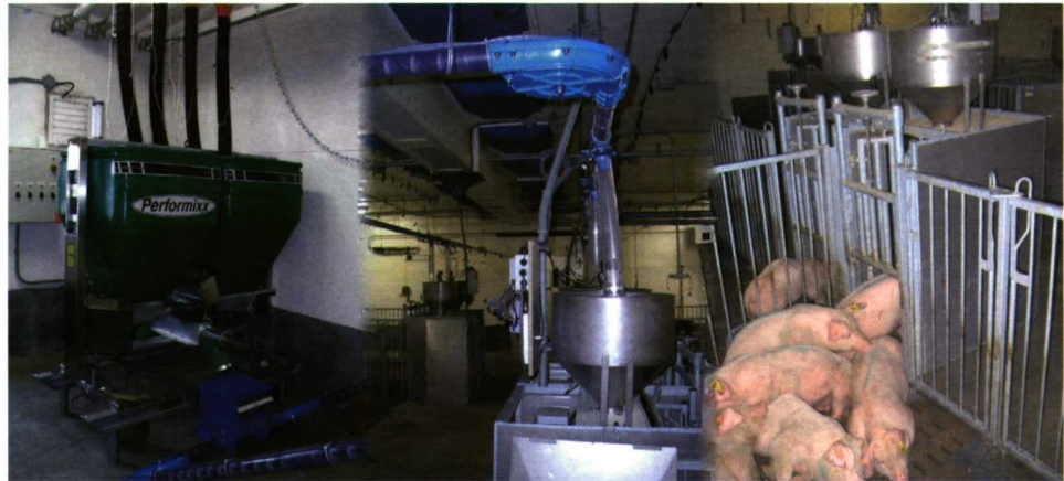
Figura 1. Primera generación de equipamiento automático de alimentación de precisión que permite suministrar pienso ajustado a las necesidades diarias de los animales.
