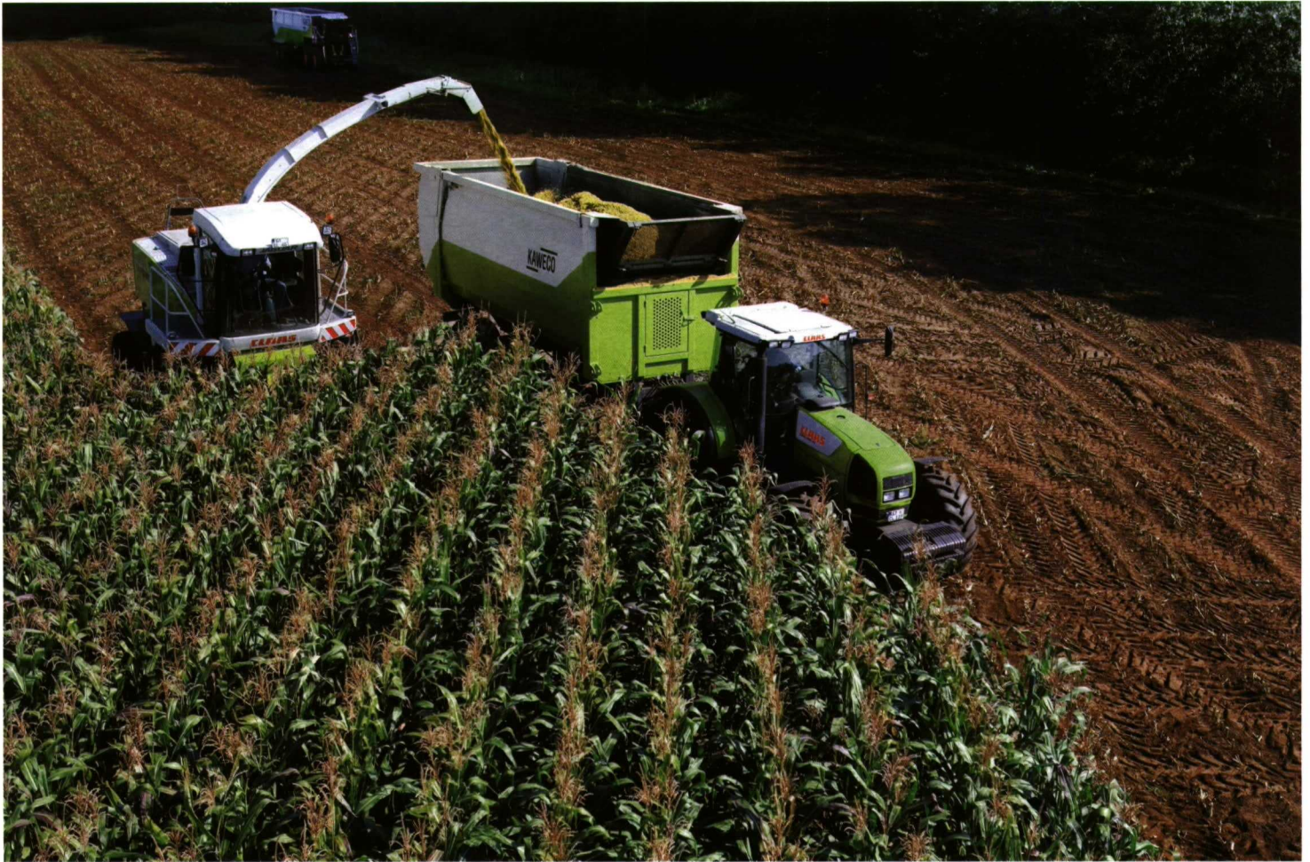
Una de las últimas novedades interesantes es la picadora de maíz que puede trabajar independientemente de las hileras de siembra, en la dirección del campo más favorable a la operación.
