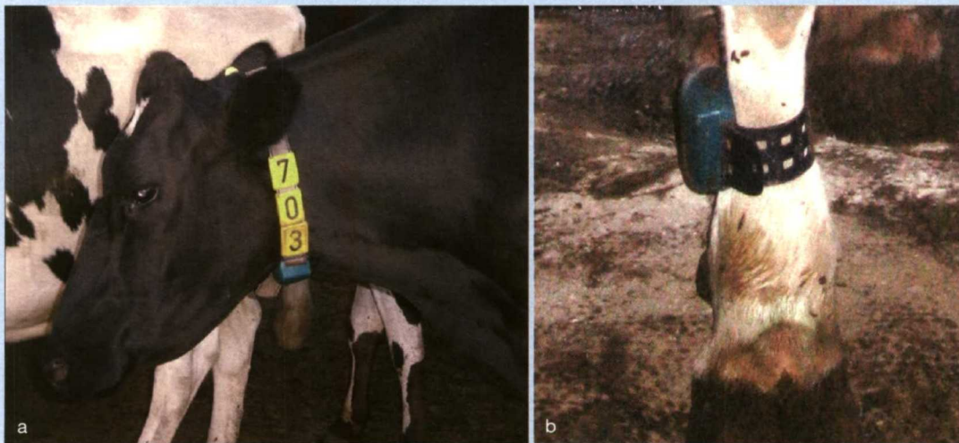
Foto 1. Versión cuello (a) y pata (b) del nuevo Rescounter II. Fuente. Foto tomada en explotación de vacas en España.
