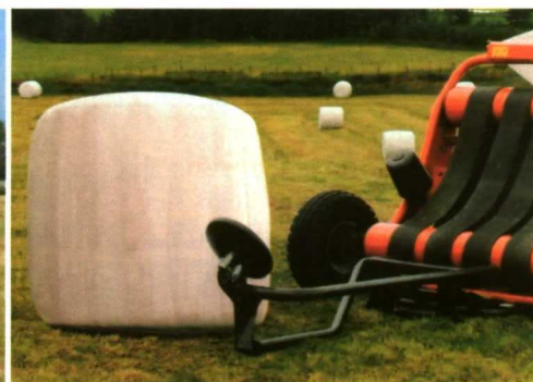
Figura 12. Sistema de descarga que garantiza el apoyo del lado plano de la paca sobre el terreno.
