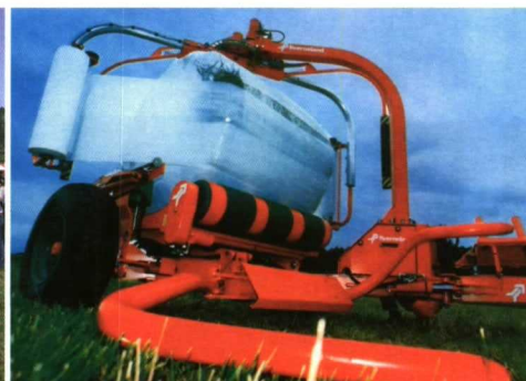
Figura 5. Encintadora con plataforma giratoria y dos brazos satélites de aplicación de film plástico.
