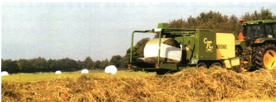
Figura 6. Máquina combinada compuesta por empacadora y encintadora.
