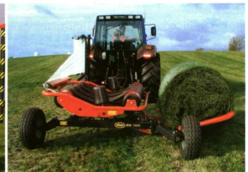
Figura 3. Encintadora con plataforma giratoria y posición fija del film plástico con sistema de carga propio.
