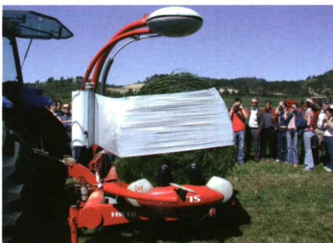
Figura 4. Encintadora con plataforma giratoria y un brazo satélite de aplicación de film plástico.
