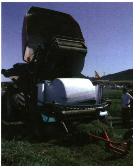
Figura 7. Encintadora incorporada a la cámara de compresión de la empacadora.
