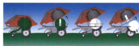
Figura 9. Modo de trabajo de una empacadora con encintadora incorporada en la cámara de compresión.
