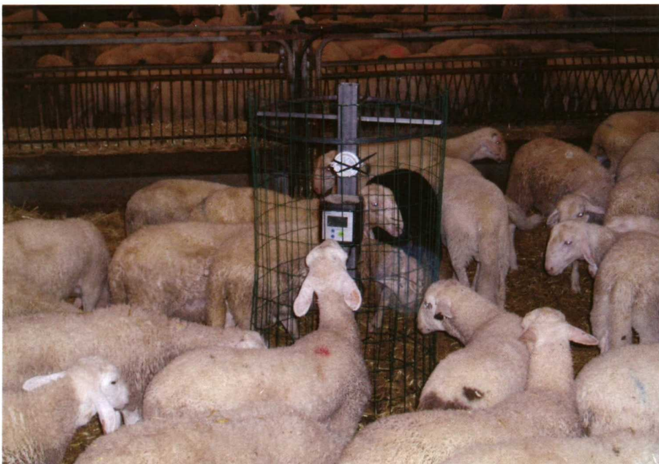
Figura 6. Ubicación de un sensor de amoníaco en un corral de corderos.
