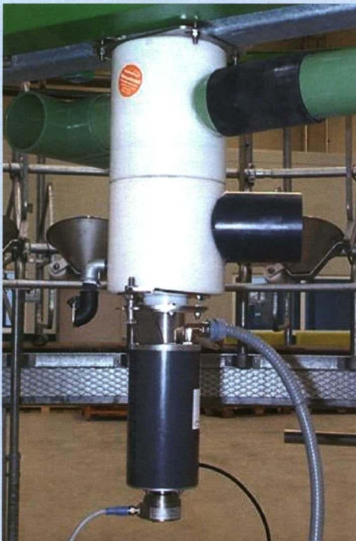
Foto 8. Racor giratorio de la sala de ordeño AutoRotor Capri.
