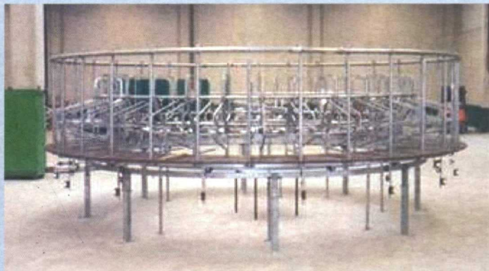
Foto 3. Detalle estructura de ordeño y obra civil de sala AutoRotor Capri. Fuente: archivos de WestfaliaSurge.
