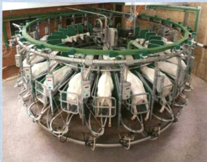
Foto 1. Vista general de una sala de ordeño rotativa AutoRotor Capri. Fuente: foto tomada en una explotación de cabras en Italia
