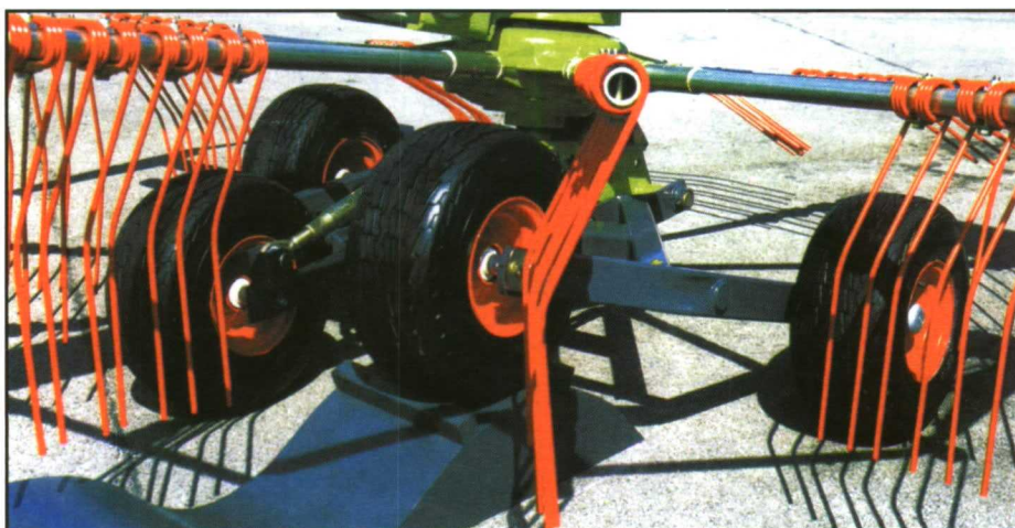
Figura 18. Rastrillo hilerador: detalle de ruedas en eje tándem. Fuente: Claas.
