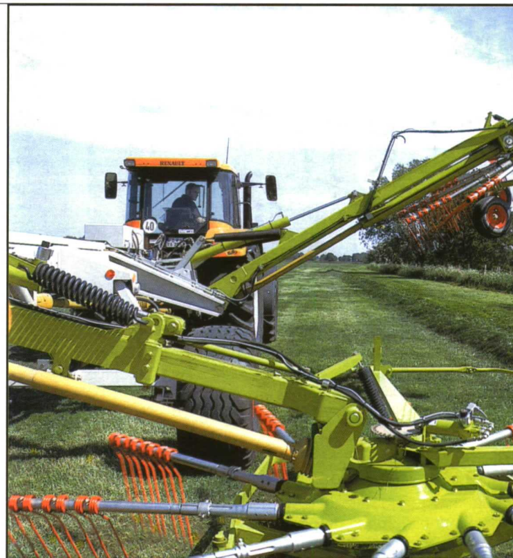
Figura 17. Rastrillo hilerador: elevación de los rotores. Fuente: Claas.
