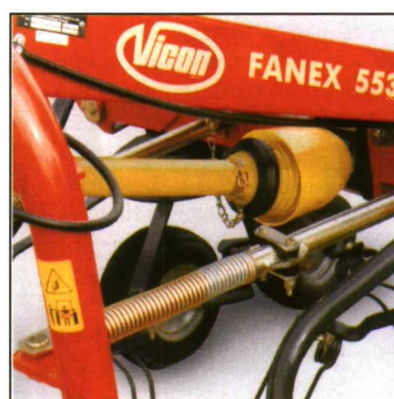
Figura 10. Rastrillo volteador: detalle de amortiguador oscilante. Fuente: Kverneland Group.
