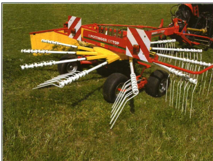
Figura 11. Rastrillo hilerador: detalle de rotor con brazos portapúas y púas. Fuente: Pottinger.
