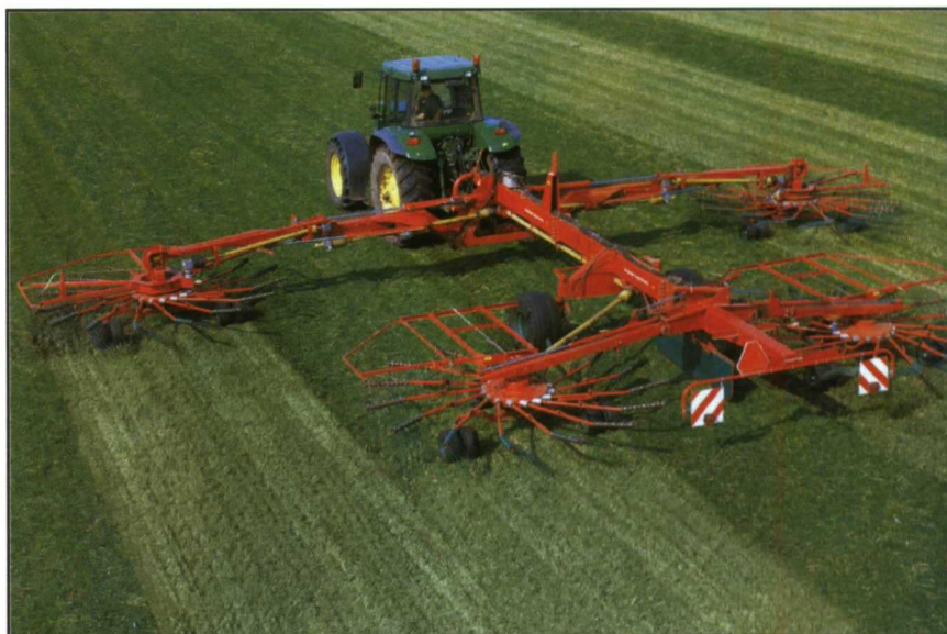
Figura 14. Rastrillo hilerador: hileradora de gran rendimiento de cuatro rotores. Fuente: Taarup.
