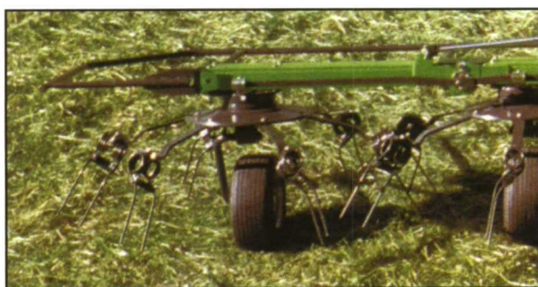
Figura 2. Rastrillo volteador: detalle de rotor con brazos portapúas y púas. Fuente: Deutz Fahr.
