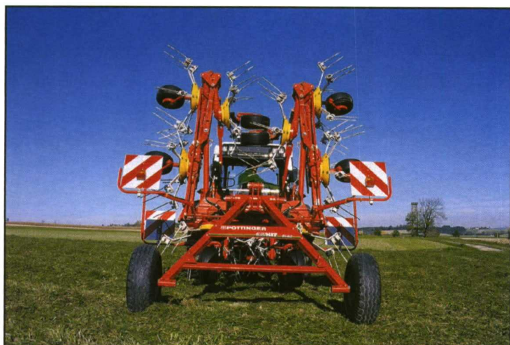
Figura 21. Rastrillo volteador: posición de transporte de rastrillo volteador. Fuente: Pottinger.
