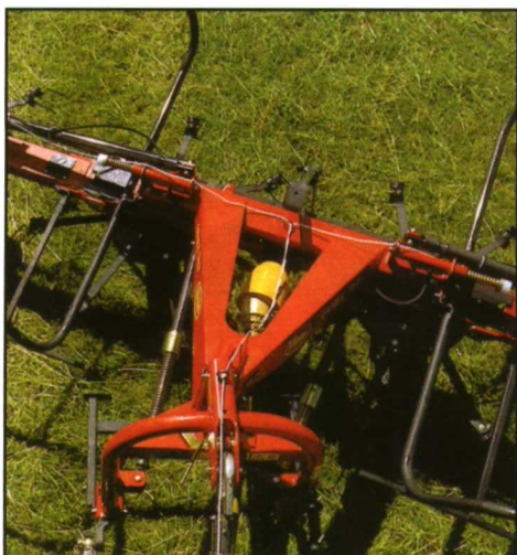
Figura 8. Rastrillo volteador: chasis intermedio de estructura triangular. Fuente: Kverneland Group.
