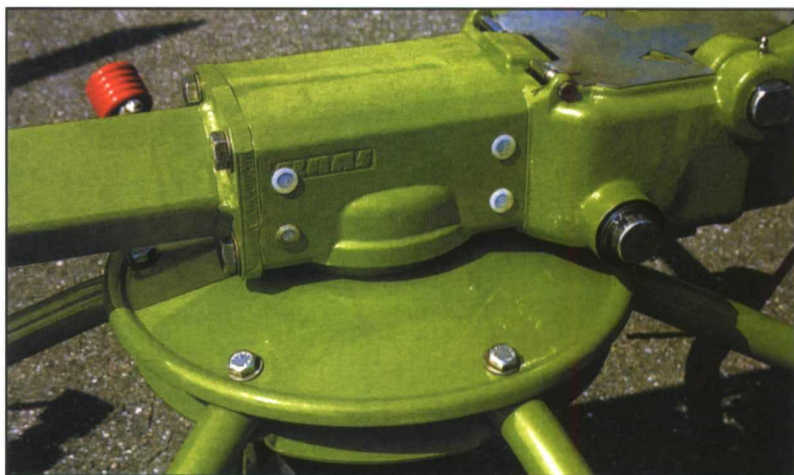
Figura 7. Detalle del cierre hermético de la cabeza del rotor. Fuente: Claas.
