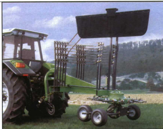
Figura 20. Rastrillo hilerador: posición de transporte de rastrillo hilerador con brazos desmontables. Fuente: Pottinger
