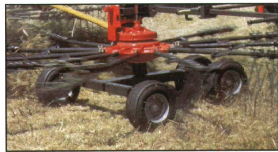
Figura 19. Rastrillo hilerador: Sistema tándem de cuatro ruedas. Fuente: Vicon
