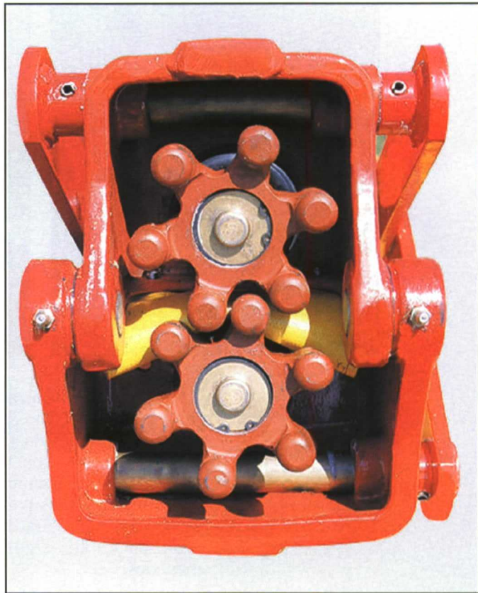
Figura 6. Rastrillo volteador: detalle del distribuidor de dedos múltiples para el accionamiento del rotor. Fuente: Pottinger.
