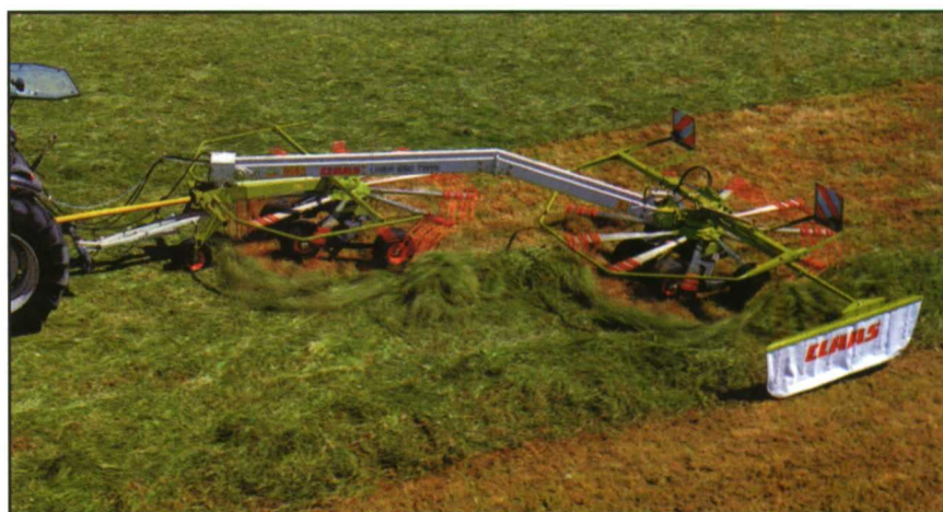
Figura 15. Rastrillo hilerador: detalle de la lona deflectora. Fuente: Claas.
