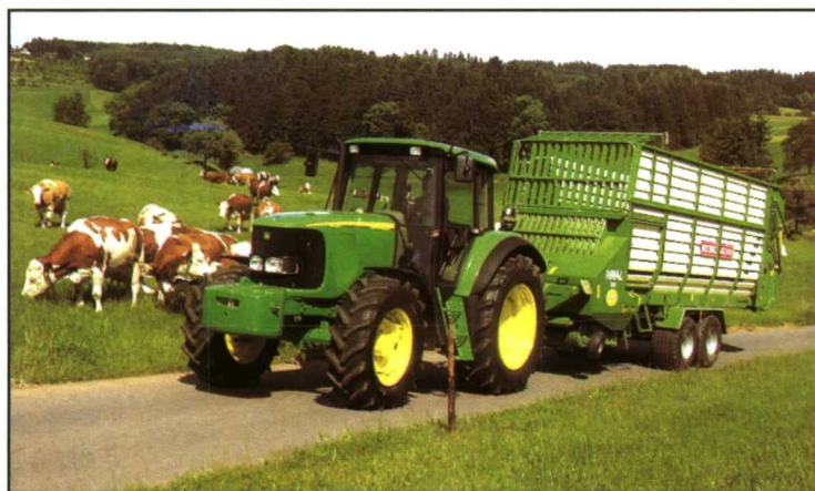
Foto 1. El transporte es una de las tareas básicas en la explotación ganadera. En este caso, además el remolque es autocargador-distribuidor.
