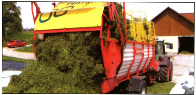
Foto 6. La descarga en silo del remolque autocargador, otra de las tareas que un tractor de 75-80 CV puede realizar perfectamente.
