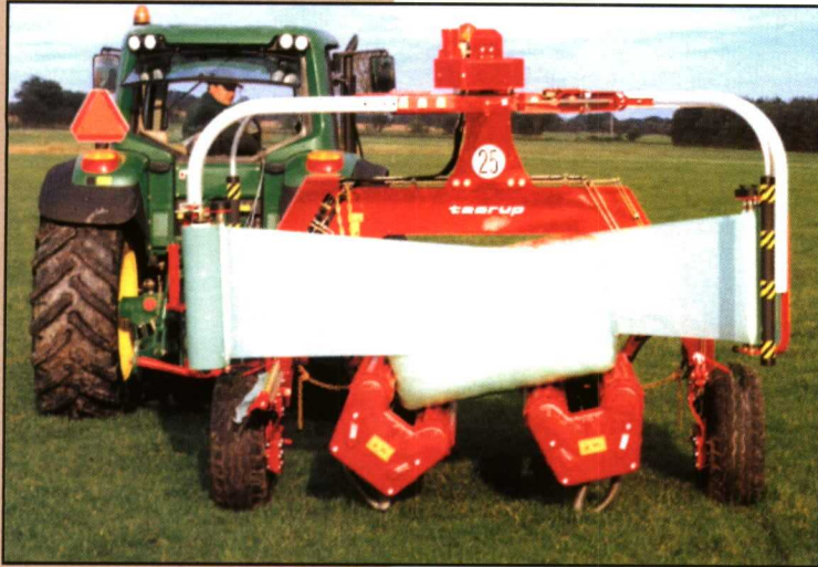
Foto 5. La "envolvedora" de pacas es otra máquina que se ha puesto "de moda" en estos últimos años y tampoco exige grandes potencias.
