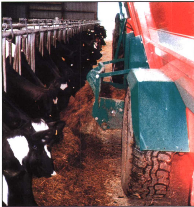
Foto 2. Distribución a lo largo del comedero con un remolque mezclador-distribuidor.
