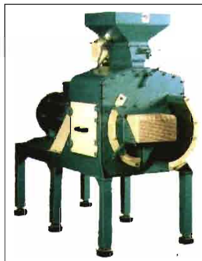
Foto 3.- Molino de martillos modelo GRI.
