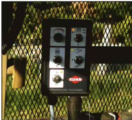
Figura 10. Consola de control en cabina.
