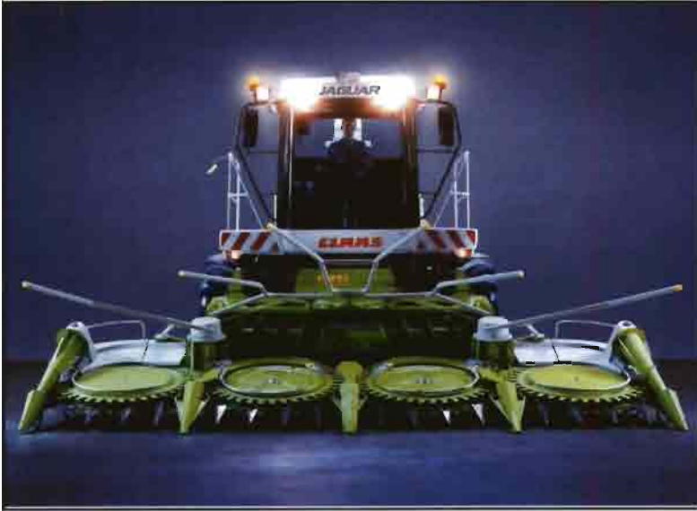
Foto 6 Cosechadora de forraje con cabezal rotativo independiente para maíz (Fuente: Claas).
