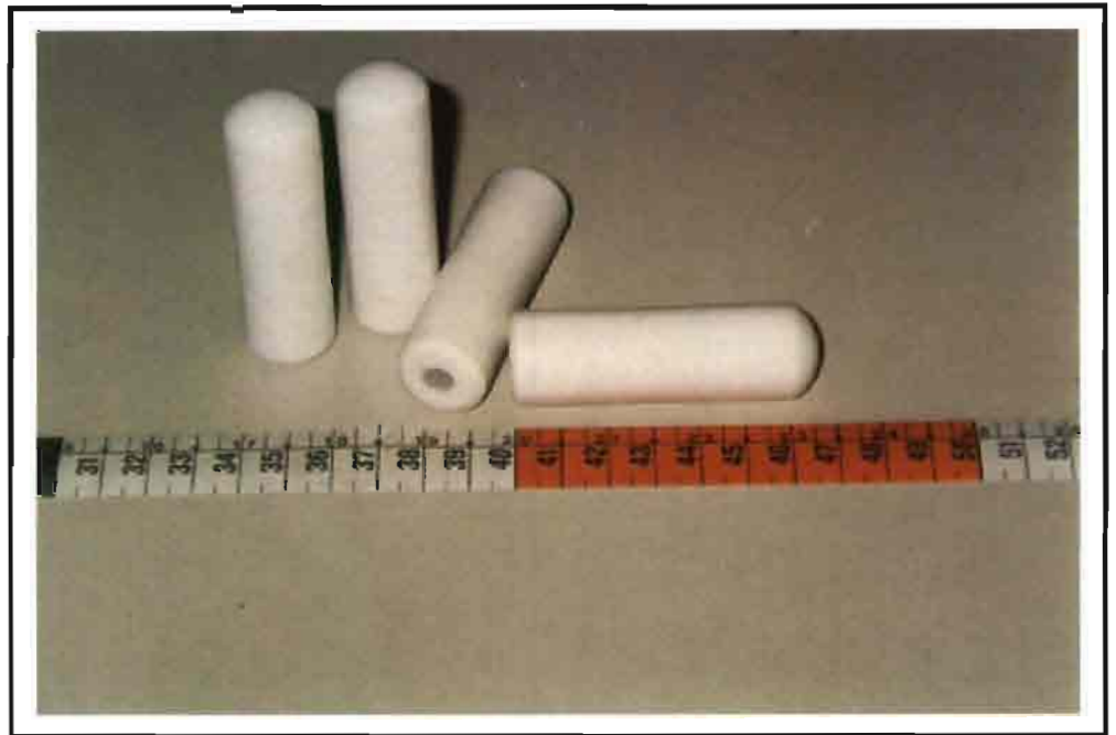
Figura 3. Bolo ruminal cerámico utilizado para la identificación electrónica de rumiantes.
