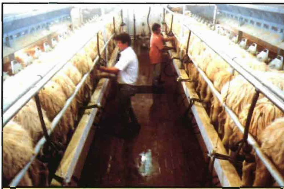
Instalación con lactoducto en línea baja con 48 puestos. (F.Manus)
