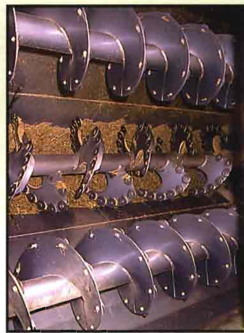
Existen instalaciones de Unifeed fijas de gran capacidad para cooperativas. A la derecha podemos ver un detalle de los sinfines de una instalación fija.
