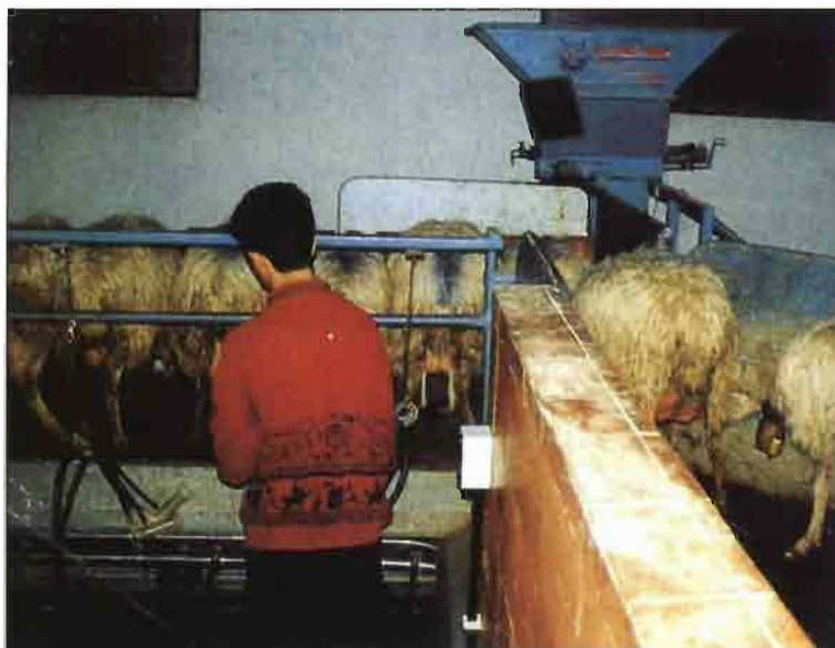
Figura 3. Al final del ordeño, la plataforma móvil se desliza hacia la salida, determinando la apertura del rastrillo que libera al primer animal.
