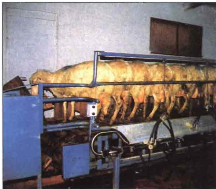
Figura 4. La salida del primer animal hace que en el otro extremo de la cinta se encuentre una plaza libre, que es ocupada por el primer animal del lote siguiente.
