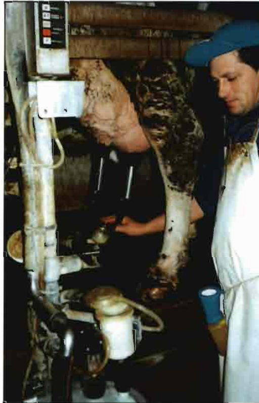
En el lavado de la instalación de ordeño hay que evitar de forma absoluta los detergentes espumosos, que podrían dañar algunos aparatos del sistema.
