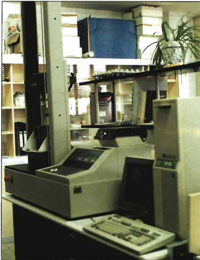
Con el sistema Instron se mide la resistencia miofibrilar, fuerza de la primera ruptura y la fuerza máxima que traduciría las propiedades del conjuntivo.
