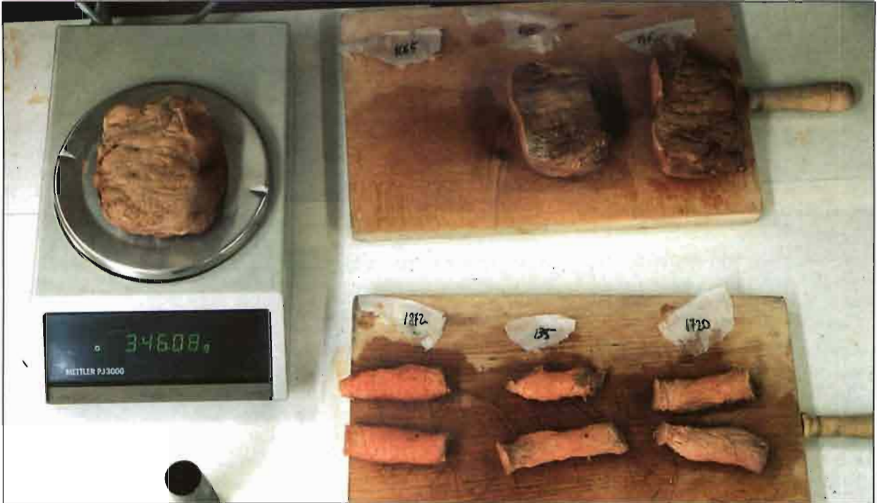
Preparación de muestras para el cálculo de la fuerza de cizalla-compresión.
