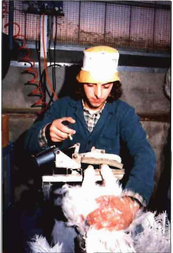
A la izquierda. Máquina automática para la fabricación de los instrumentos empleados en la fecundación de las pavas.
