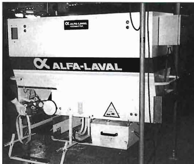
Fig. 13. La distribución de los forrajes en bruto en los establos con estabulación fija puede automatizarse mediante carrillos dosificadores que se mueven sobre rail (Fuente Alfa-Laval).
