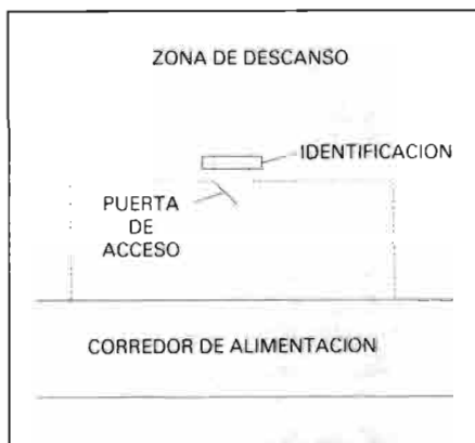
Fig. 5. El acceso a la zona de alimentación se puede permitir sólo a un grupo de animales mediante puertas y sistemas de identificación de los animales.
