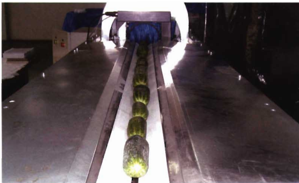
Figura 1: Vista desde atrás del prototipo experimental, compuesto por una doble banda en V (bandas o cintas de color blanco) y el anillo óptico, al fondo en color negro.
