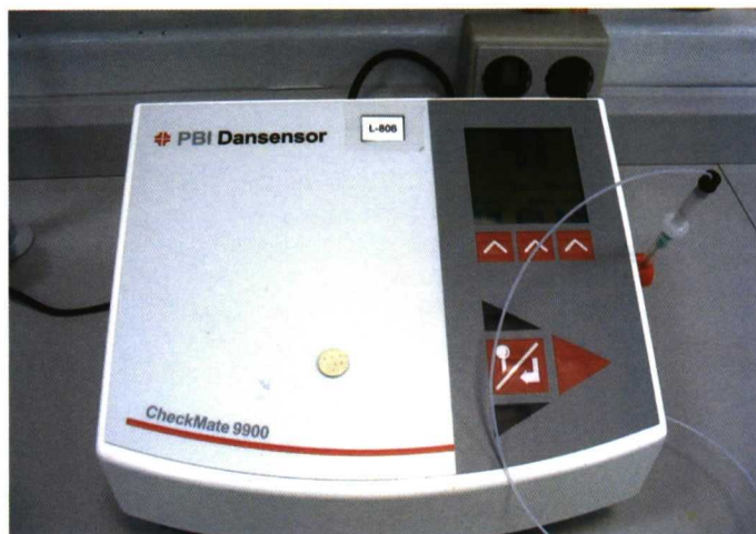
Oxímetro y cámara estanca para determinar la tasa respiratoria.
