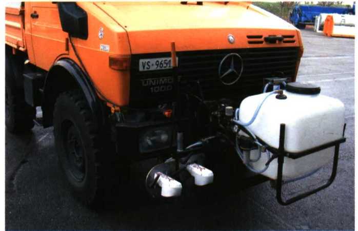
Montaje del Weedseeker delante de un camión. Su uso está destinado para desbroce enfocado en las carreteras.
