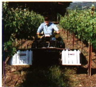
Detalle de montaje del Weedseeker encima de un quadm para el uso en desbroce en líneas de uva de EEUU.
