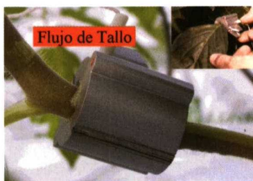
En la imagen, un sensor que monitorea el flujo de savia.
