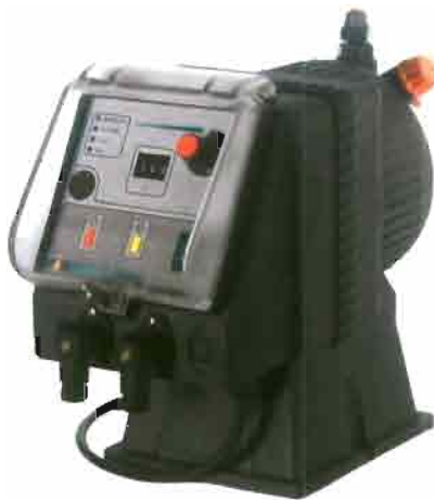
Las bombas dosificadoras Dositec-P trabajan con caudales proporcionales en base a una señal procedentes de un contador de impulsos o de un caudalímetro de alta frecuencia.
