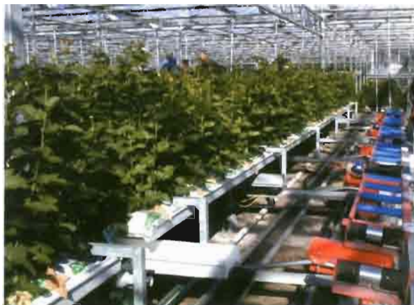
Banqueta móvil frente al transportador que le transporta hasta la próxima nave.
