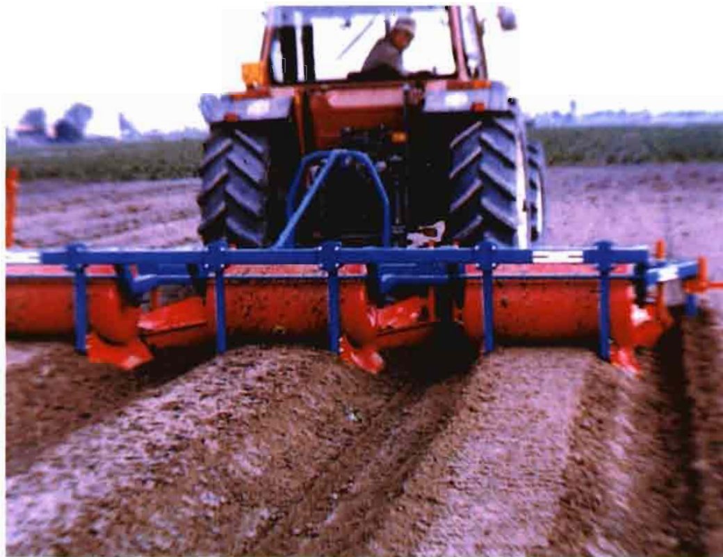
Arriba: cosechadora de lechugas autoguiada, con mesa de confección. Abajo, una fresadora conformadora en la preparación de suelos
