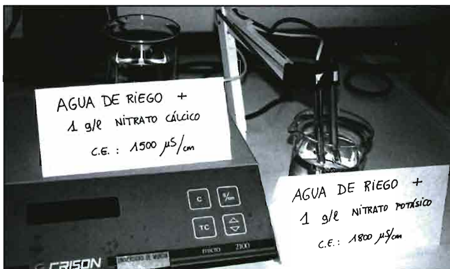
Medida en laboratorio del incremento de CE tras la adición de fertilizantes al agua de riego
