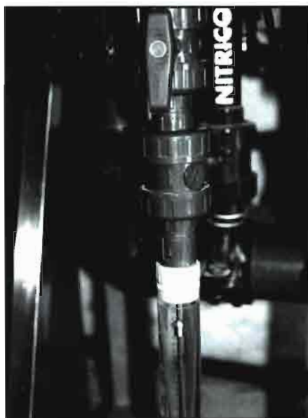
Inyección de ácido nítrico por efecto venturi en un equipo automático de fertirrigación para ajuste del pH de la solución nutritiva al valor deseado
